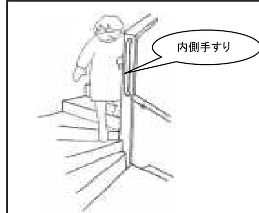
廻り階段の内側は階段の踏み面が狭く、階段を踏み外す危険性が増してしまいます。斜め手すりと併せて縦手摺を設けると安全に移動できます。
